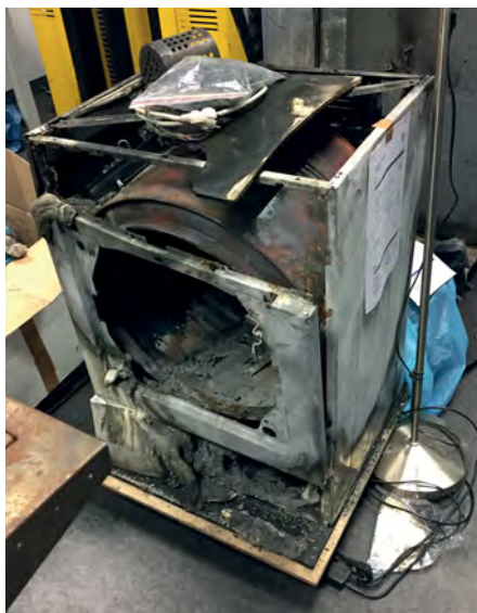
Kühlschränke, Waschmaschinen, Gasterne: In der Niederlassung München des IFS stapeln sich Haushaltsgeräte, die gebrannt haben. Dann untersucht Lorenz Wiegleb (Foto), ob zum Beispiel ein technischer Defekt am Gerät oder unsachgemäße Handhabung den Brand ausgelöst haben.
