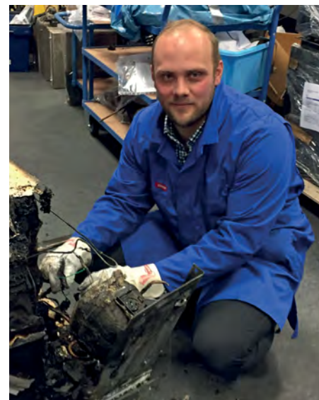
Kühlschränke, Waschmaschinen, Gasterne: In der Niederlassung München des IFS stapeln sich Haushaltsgeräte, die gebrannt haben. Dann untersucht Lorenz Wiegleb (Foto), ob zum Beispiel ein technischer Defekt am Gerät oder unsachgemäße Handhabung den Brand ausgelöst haben.
