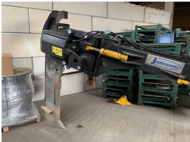
Der Kabelpflug der Fiber Network WUG: Mit ihm lassen sich Kabel in einem Arbeitsgang bis zu einen Meter tief in den Boden einführen.
