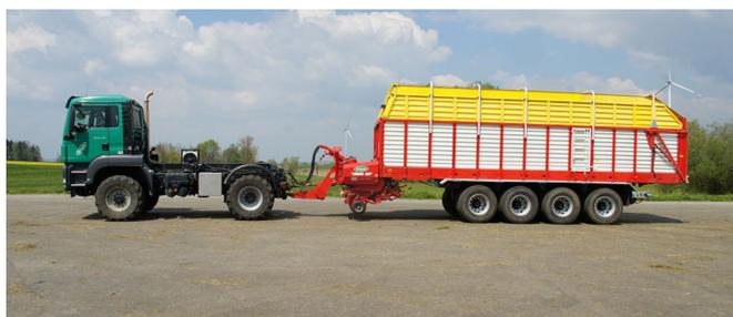
Schnell und bodenschonend: Der vierachsige Ladewagen ist eine Gemeinschaftsentwicklung der Futtertrocknung Lamerdingen eG mit einem Landmaschinenhersteller. Foto: Futtertrocknung Lamerdingen eG
